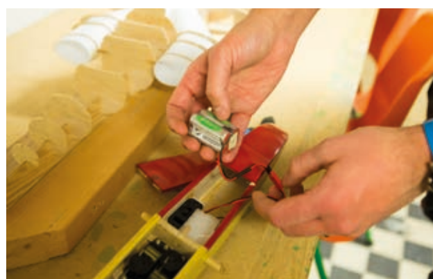
På vintern blir det en del fix. Här byts batteripaketet till styrningen av ett modellglidflygplan.
